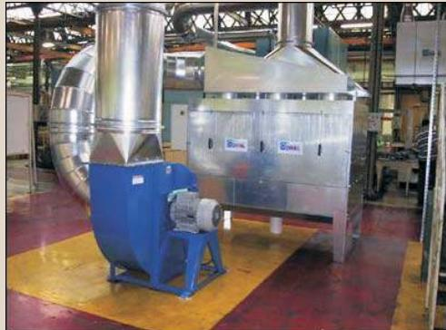
Filtre Clean-fv il est utilisé par les industries mécaniques et graphiques, ainsi que dans les secteurs où il est nécessaire de purifier l'air des brouillards huileux produits par les usinages et de récupérer l'huile filtrée de façon à la recycler.
