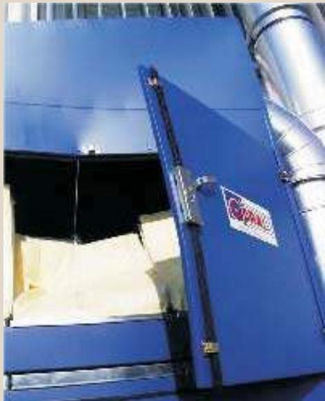
Der CLEAN-FV Filter wird in der mechanischen und grafischen Industrie sowie in Bereichen eingesetzt, bei denen die Notwendigkeit besteht die Luft von öligen, bei der Verarbeitung entstandenen Nebelschwaden zu reinigen und das gefilterte Öl für die Wiederverwertung zurückzugewinnen.
