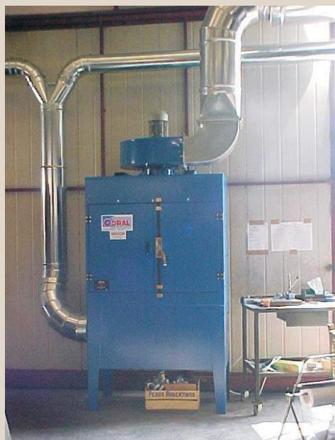
Filtro CLEAN-FV se emplea en industrias mecánicas, gráficas y de otros sectores en los que sea necesario purificar el aire de la neblina de aceite provocada por los trabajos de producción, y recuperar el aceite filtrado permitiendo su reciclaje.
